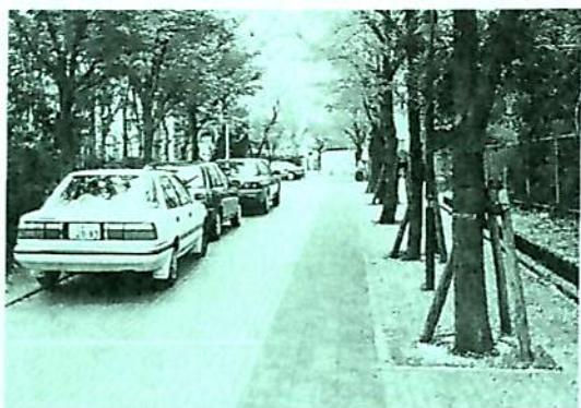
桜丘プロムナード（世田谷区桜丘） 桜丘区民センターの建設をきっかけに、区民センターと周辺の公共施設を結ぶ道を整備。歩道と車道を一体とし、歩行者優先の道をつくった。
